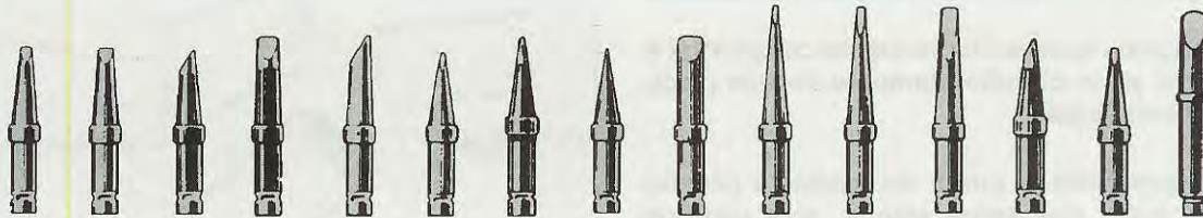
Fig.145 Tutti i saldatori professionali, cioè quelli più costosi, sono dotati di una serie di punte intercambiabili che possono avere forme diverse. Le punte sottili vengono adoperate per stagnare terminali molto ravvicinati, le punte medie per normali stagnature e le punte più lunghe per stagnare superfici che potrebbero raffreddare una punta sottile.
