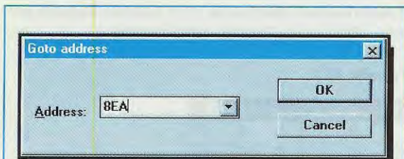
Fig.131 Poiché dovete correggere l'istruzione set 2, port_b , nella finestra Goto Address digitate 8EA , che è l'indirizzo di memoria Program Space di questa istruzione. Quindi cliccate su OK .
