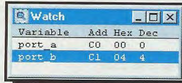
Fig.127 Controllando la finestra Watch vi accorgete che sebbene il contenuto di port_a sia 00, il contenuto di port_b è 04.
