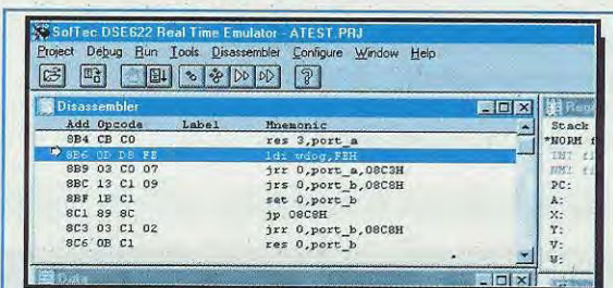
Fig.90 Se in fase di compilazione non è stato creato il file .SYM , nel file .PRJ le etichette sono codificate in esadecimale.
