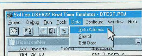
Fig.124 Per portare a livello logico 0 i piedini della porta A, dal menu Data scegliete Goto Address .
