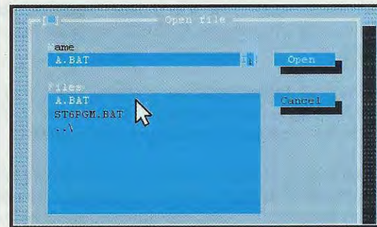
Fig.94 Il file che dovete modificare per generare il file .SYM si chiama A.BAT .
