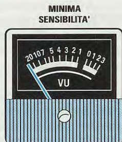
Fig.4 Ruotando il potenziometro R9 in modo da far deviare la lancetta dello strumento tutta sulla sinistra si ottiene la minima sensibilità.
