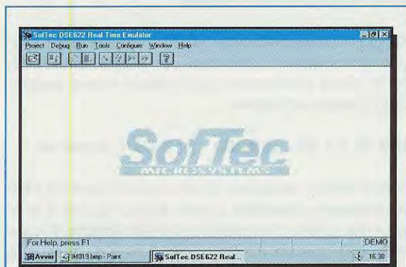
Fig.97 Dopo il nome del DSE, nella prima riga in alto trovate la barra dei menu a tendina, nella riga immediatamente sotto trovate la barra delle icone o degli strumenti che vi consente di accedere rapidamente ai comandi di frequente utilizzo.
