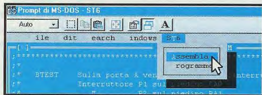
Fig.138 Prima di chiudere il file dovete ricompilare il programma BTEST.ASM , quindi dal menu ST6 scegliete Assembla .
