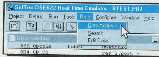
Fig.104 Scegliendo il sottomenu Goto Address potrete posizionarvi direttamente sul valore esadecimale dell'indirizzo di memoria in cui è memorizzata la variabile.
